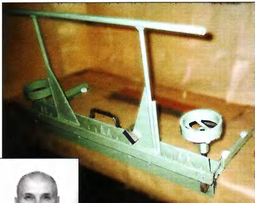
Автор конструкции В. Андрианов и его гибочный станок, закрепленный на верстаке.
