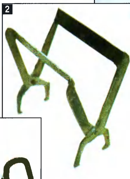
Захват для рамок, детали которого вырезаны из листового металла. Размеры деталей захвата показаны на рисунке.
